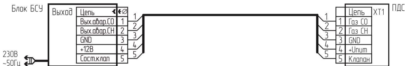
Рисунок 1 – Типовая схема подключения
